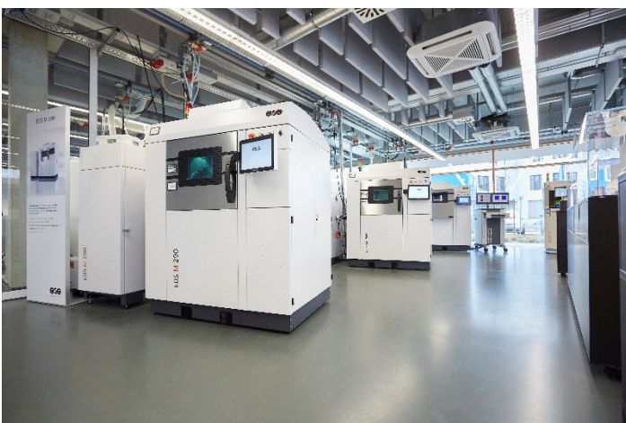
BU: Als erstes industrielles 3D-Druck-System für Direkt-Metall-Laser-Sintern ist die EOS M 290 serienmäßig mit dem Qualitätsüberwachungssystem Exposure OT lieferbar.
